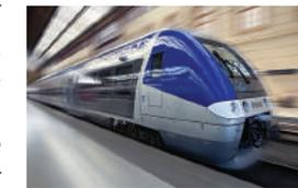
de ces trains nouvelle génération. Les données sont collectées en temps réel afin de pouvoir détecter à distance, pendant que les trains circulent, d'éventuels problèmes techniques sur les rames, par exemple sur la fermeture des portes ou sur le système de climatisation.
